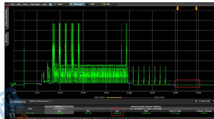
NB-IoT 模块，PSM模式耗电2.868uA，工作时最大电流为206.75mA，相差10万倍。
